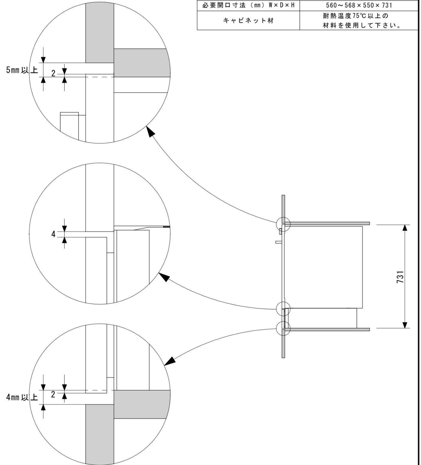
※上下に来る面材の間隔=740mm以上、左右に来る面材の間隔=600mm以上
