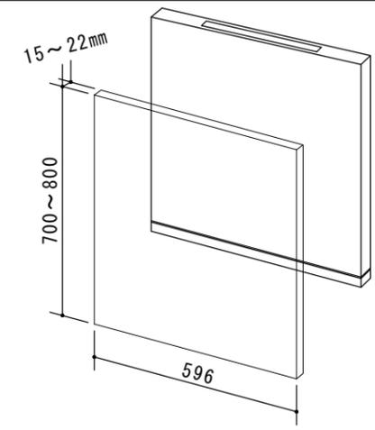
●全面化粧ドア使用时下部、排気口をスライドする事により必要なドア材寸法を決定します。
