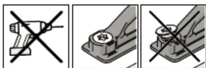
**注意** : ネジは電動工具を使わず手締めで願います。
