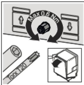
後脚は T20トルクスドライバー又は 1/4 ボックスレンチを使って後脚の高さを調整してください。
