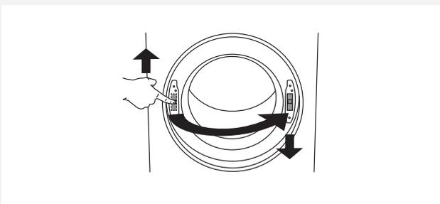
**4** ドアロックを押し上げて外してください。ロックを反対側に移動して、押し下げてください。
