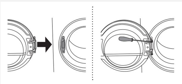
**10** ドアをドアヒンジに取り付けて締めてください。
