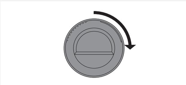
**8** ドアガラスカバーを、ドア開マークが反対側にくるまで、90度回してください。
