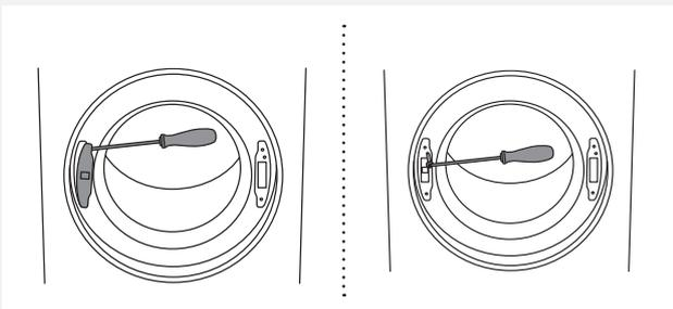
**3** ドライバーでドアロックカバーを外して、ドアロックのねじを緩めてください。
