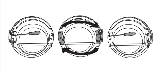
**6** ドアヒンジ(左部)とドアラッチ(右部)のねじを緩めて、両部品を位置を入換えてから、再度ねじを締めてください(ドアヒンジは右側、ドアラッチは左側に)。
