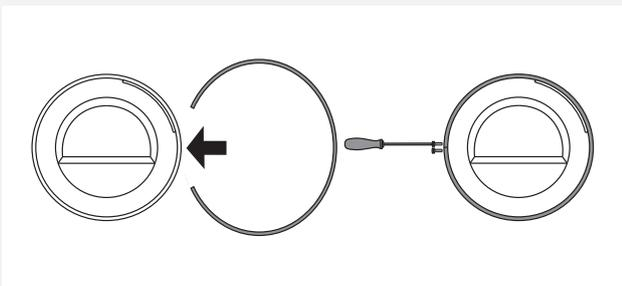
**9** ドアリングを180度回して、ドアに取り付け、締めてください。
