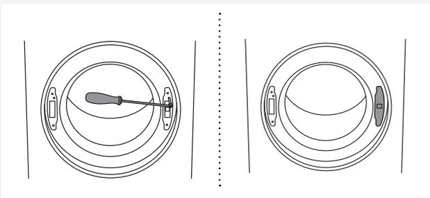
**5** ドアロックのねじを締めて、ドアロックカバーを再度取り付けてください。
