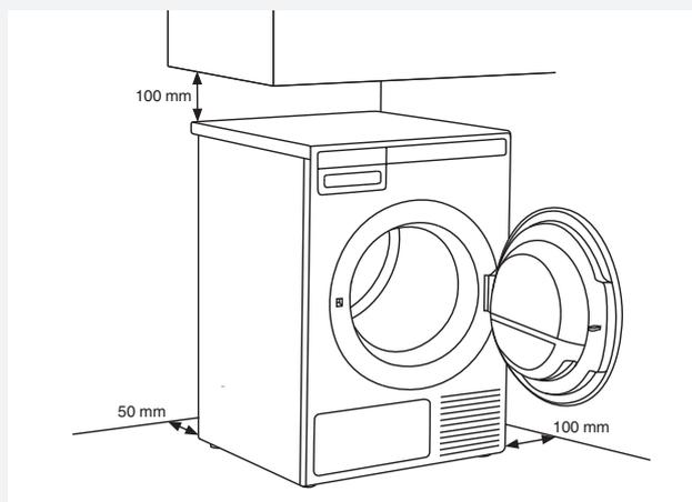
💡 乾燥機を壁や家具に接触しないようにしてください。最適な運転のために乾燥機を写真通りに壁から離すことをお勧めします。
