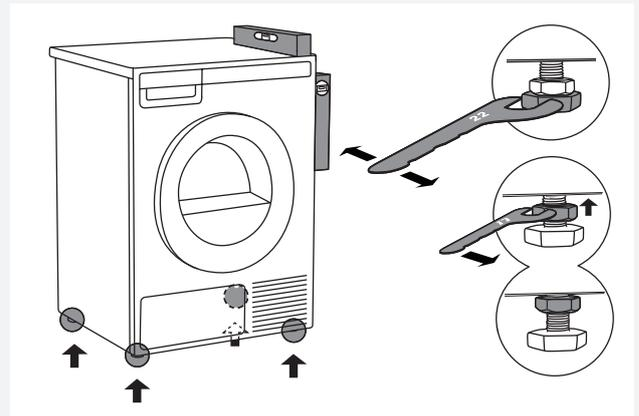
乾燥機を安定に設置してください。水平かつ均等に設置するために水準器を使用して22スパナで調節可能な脚を回してください(最大15mm)。設置調整後は、17スパナでロックナットを機械の底に向かって↑しっかり締めてください。
