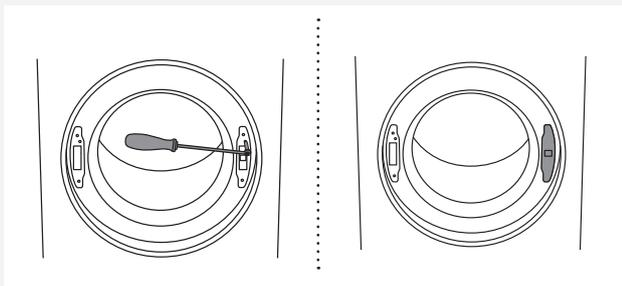
**5** ドアロックのねじを締めて、ドアロックカバーを再度取り付けてください。
