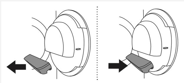
乾燥機ドアの糸くずフィルターハウジング**全体**をうっかり取り外してしまった場合、同じ位置に取付けし直してください。
