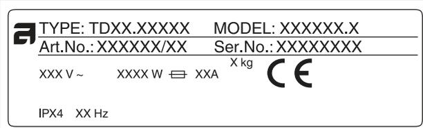
本乾燥機の情報は定格プレートに表示されています。タイプAのプレーカーを使用してください。
