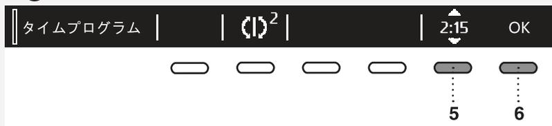
6ボタン(OK)で選択した乾燥時間を確定します。**スタート/一時停止**▶ ボタンを押すと乾燥を開始します。
