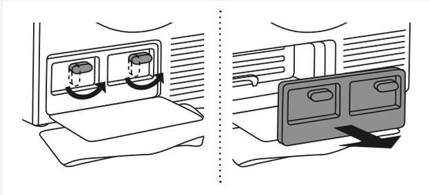
**2** 内部カバーの2本のレバーを持ち上げて、上に回してください。内部カバーを外してください。
