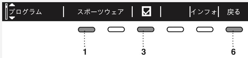
▼が表示するために1ボタンを押して下さい。プログラム選択ノブ又は1ボタンでプログラムを選びます。プログラムを表示するかどうか、3ボタンで確定します：
