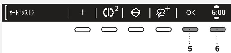
が表示するためにxボタンを押して下さい。プログラム選択ノブ、又は6ボタンにより、30分から6時間の間で30分単位で、6時間から24時間の間で1時間単位で、スタート遅延時間を設定できます。
