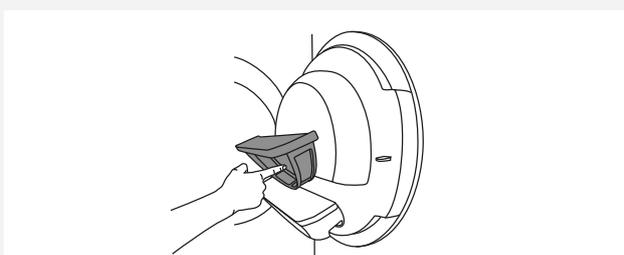
**3** 糸くずを糸くずフィルターから注意深く除去してください。
