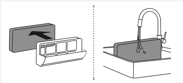
**4** フィルターのスポンジの部分をハウジングから抜いて下さい。スポンジ部を流水で洗い、完全に乾かしてから、ハウジング内へ戻してください。
