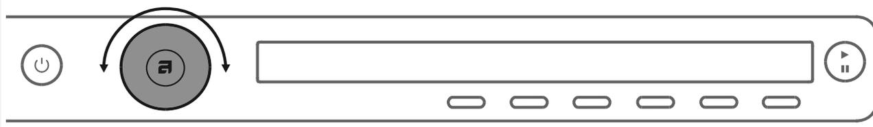
ディスプレイに矢印
