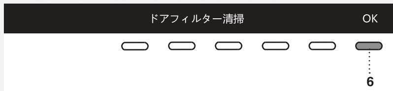
ドア内の糸くずフィルターを掃除してください(「掃除・お手入れ」を参照してください)。
