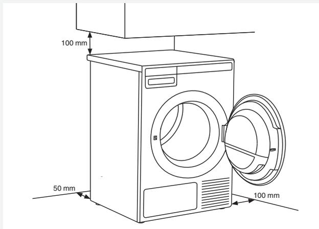
💡 乾燥機を壁や家具に接触しないようにしてください。最適な運転のために乾燥機を写真通りに壁から離すことをお勧めします。
