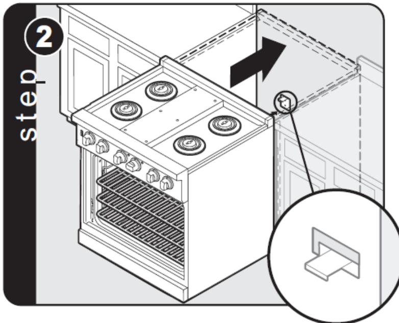
壁面、又は床面委取り付けた転倒防止金具が機器にセットされるよう確認をしながら、機器を押し込んでください。
