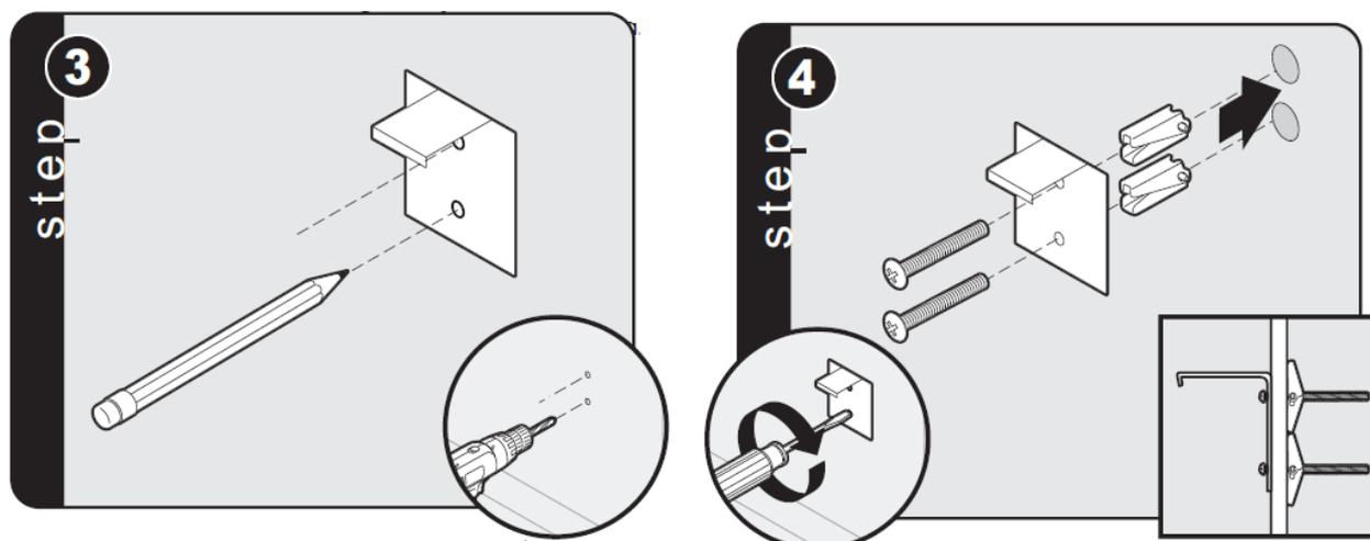
転倒防止金具を壁に固定してください。
