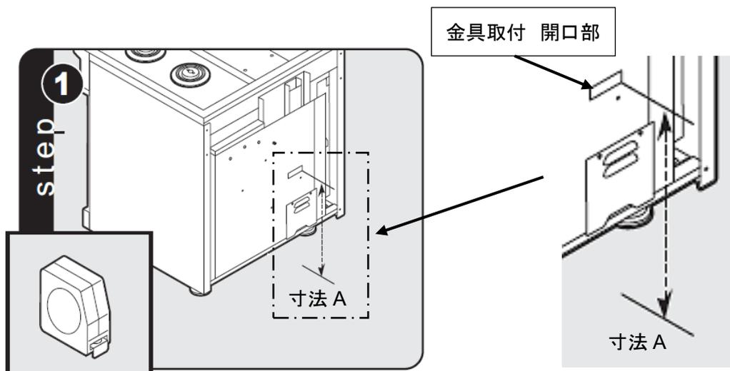
床から金具取付開口部までの寸法 A を測定してください。
